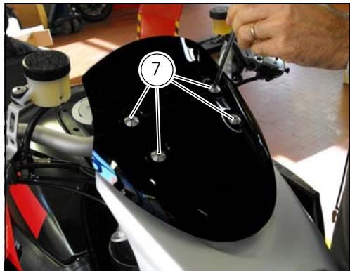
Appuyer la bulle en carbone pré-montée sur le pontet en centrant les entretoises sur les vis spéciales.
